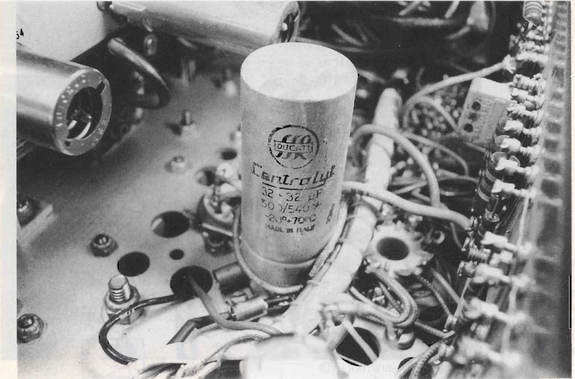
figura 7 - Il condensatore da 32+32\mu\text{F} 500V, (alla sua base si intravede il diodo da 3A dentro un'aletta di raffreddamento).
